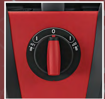
Nur für VCE 22 M MC 2x18.0: Wahlschalter Saugdurchmesser von 32 mm oder 21 mm für einen optimalen Volumenstrom
